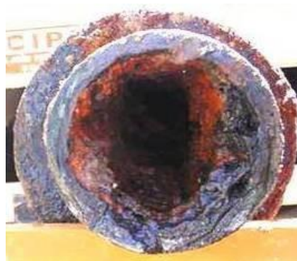
Состояние трубопровода до запуска Гидрофлоу Состояние трубопровода через 13 недель
