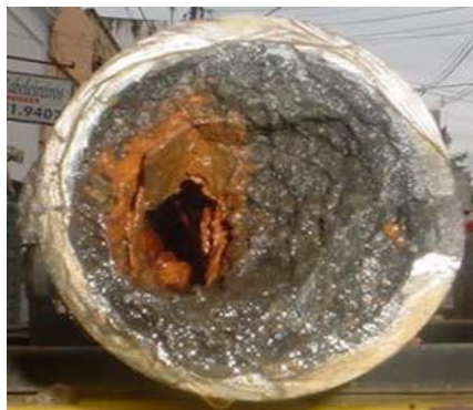
Состояние трубопровода до запуска Гидрофлоу Состояние трубопровода через 13 недель
