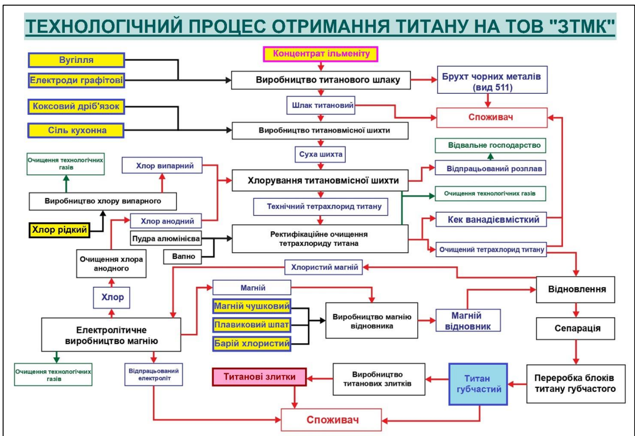
Мал.10 Технологічна схема отримання металевого титану на Запорізькому титано-магнієвому комбінаті [11].
