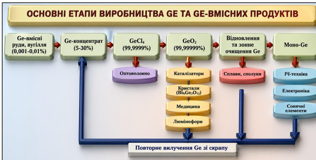
Мал.3 Схема етапів виробництва германію та германієвмісних продуктів і їхнього повторного вилучення зі скрапу. Авторський Малюнок за матеріалами [8]
